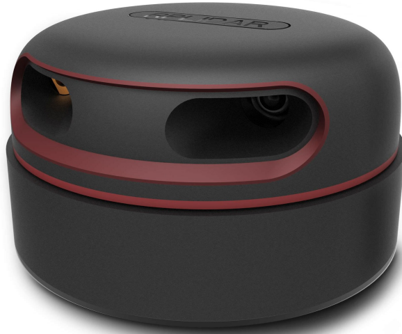
Abbildung 2.9: Abbildung des in dieser Bachelorarbeit verwendeten RPLIDAR A2 . Bei Inbetriebnahme rotiert die obere Hälfte des Sensors, die durch die untere rote Linie im Zentrum der Abbildung markiert ist. [19]
